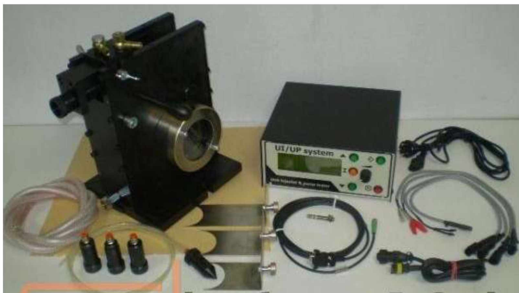
Рисунок 1.3 – Cam-Box для випробування насос-форсунок
