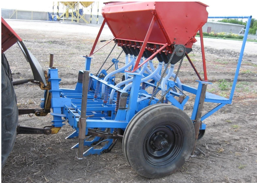
Рис. 1. Загальний вигляд сівалки для прямої сівби зернових культур Джерело: фото авторів
