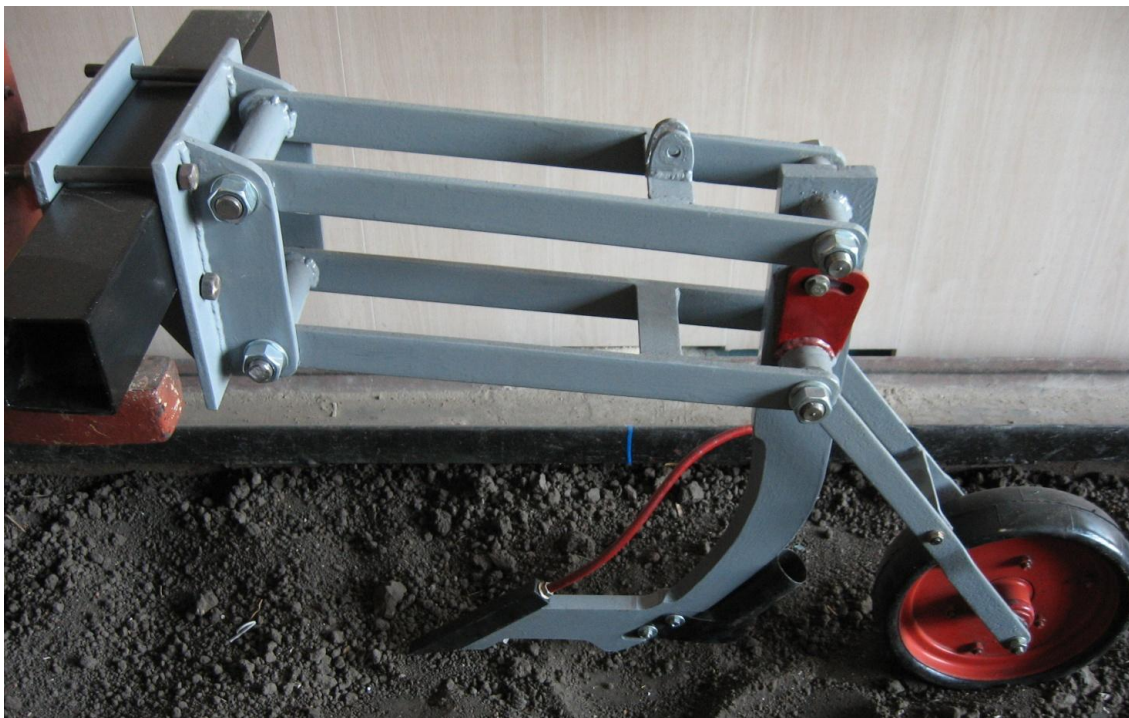
Рис. 2. Схема та загальний вигляд посівної секції
