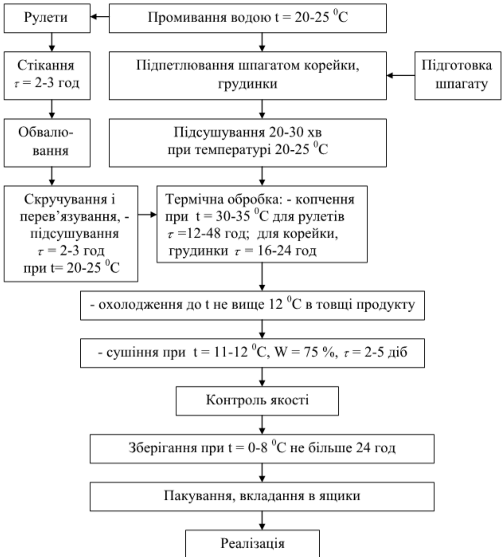
Рис. А.5. Технологічна схема виробництва сирокопчених рулетів, корейки та грудинки зі свинини
