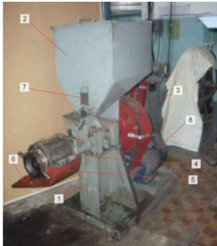
Рисунок 2.1 – Двозахідний шнековий прес для віджиму олії з насіння соняшника: 1 - корпус; 2 - приймальний бункер; 3 - циліндр преса; 4 - зерна камера; 5 - фільєра; 6 - лоток відводу олії; 7 - заслінка; 8 – електродвигун
