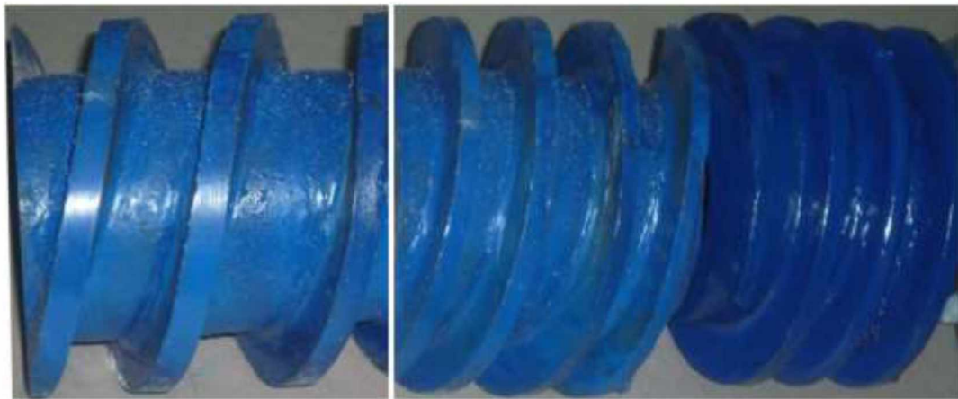
Рисунок 2.2 – Двозахідні конусні живильники з кроком 35 мм, 40 мм і 45 мм.
