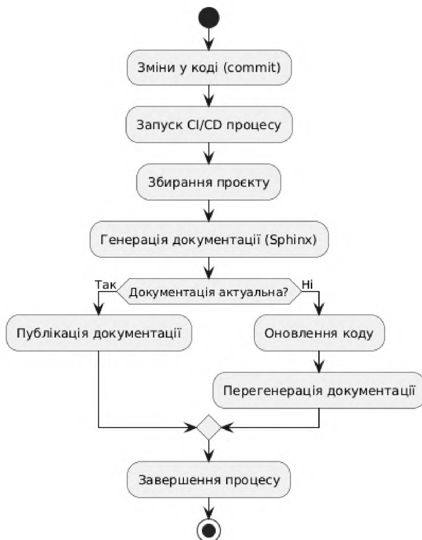
Рисунок 2.3 – Алгоритм автоматизації створення документації IT-проєкту за допомогою Jenkins
