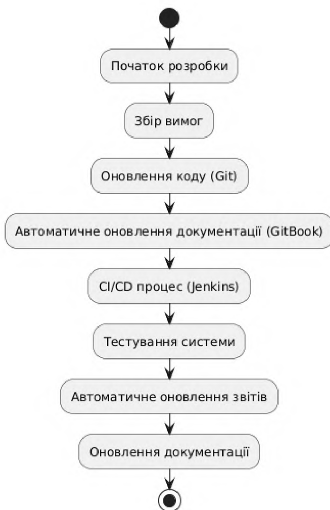
Рисунок 1.3 – Процес автоматизованого документування за методологією DevOps з використанням GitBook
