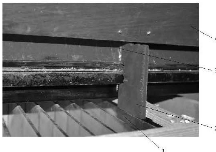
Рисунок 3.6 – Тарування бункера при визначенні рівномірності вивантаження сипучого матеріалу: 1 – бічна стінка приймального пристрою; 2 – додаткова вставка; 3 – бічна стінка бункера; 4 – торцева стінка бункера
