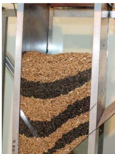
Рисунок 4.2 – Перехід з гідравлічного виду витікання до нормального при \theta = 45^\circ
