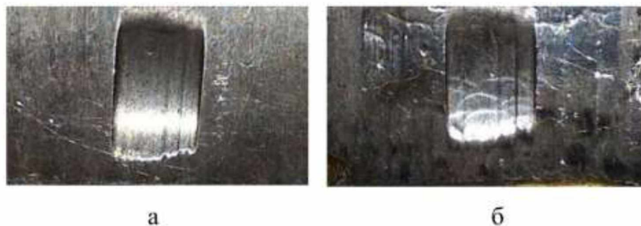
Рисунок 2.3 – Відбитки зносів випробовуваних матеріалів на машині ИМ-01: а – сталь 65Г; б – сталь У12А
