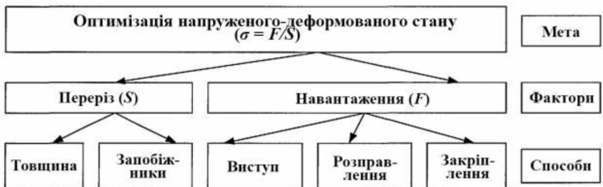
Рисунок 1.6. Способи зниження напружено-деформованого стану шатунних вкладишів
