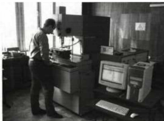
Мал. 2.11 Високоточний контроль просторової геометрії відремонтованих головок блоку на координатно-вимірювальній машині Carl Zeiss Jena DKM1-300DP
