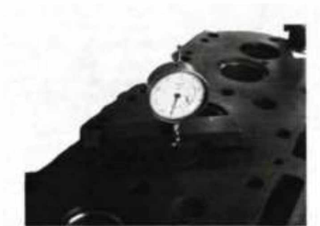
Мал. 2.7 Індикаторний пристрій для вимірювання утопання тарілки клапана щодо привалочної площини ГБЦ
