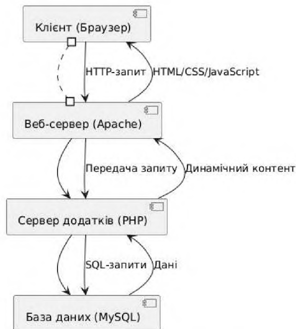
Рисунок 1.2 – Схема клієнт-серверної архітектури вебдодатка
