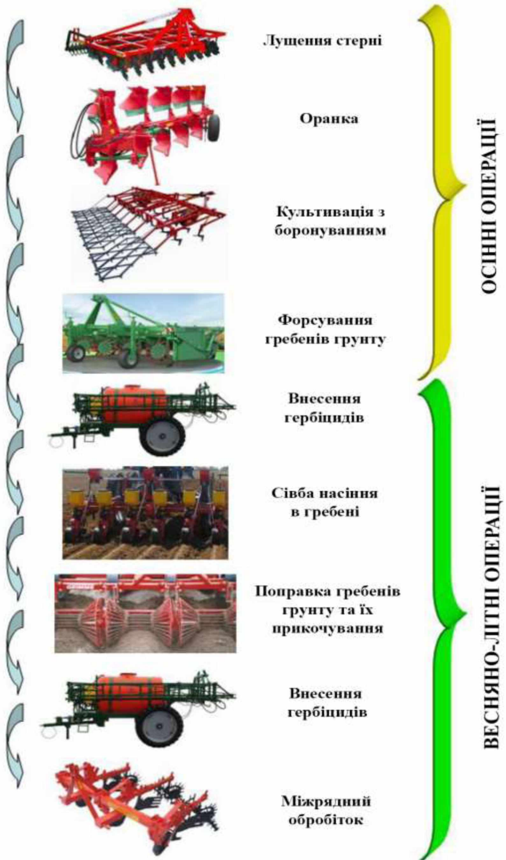
Рисунок 3.1 – Схема технологічного процесу обробітку просапних культур за існуючою гребеневою технологією
