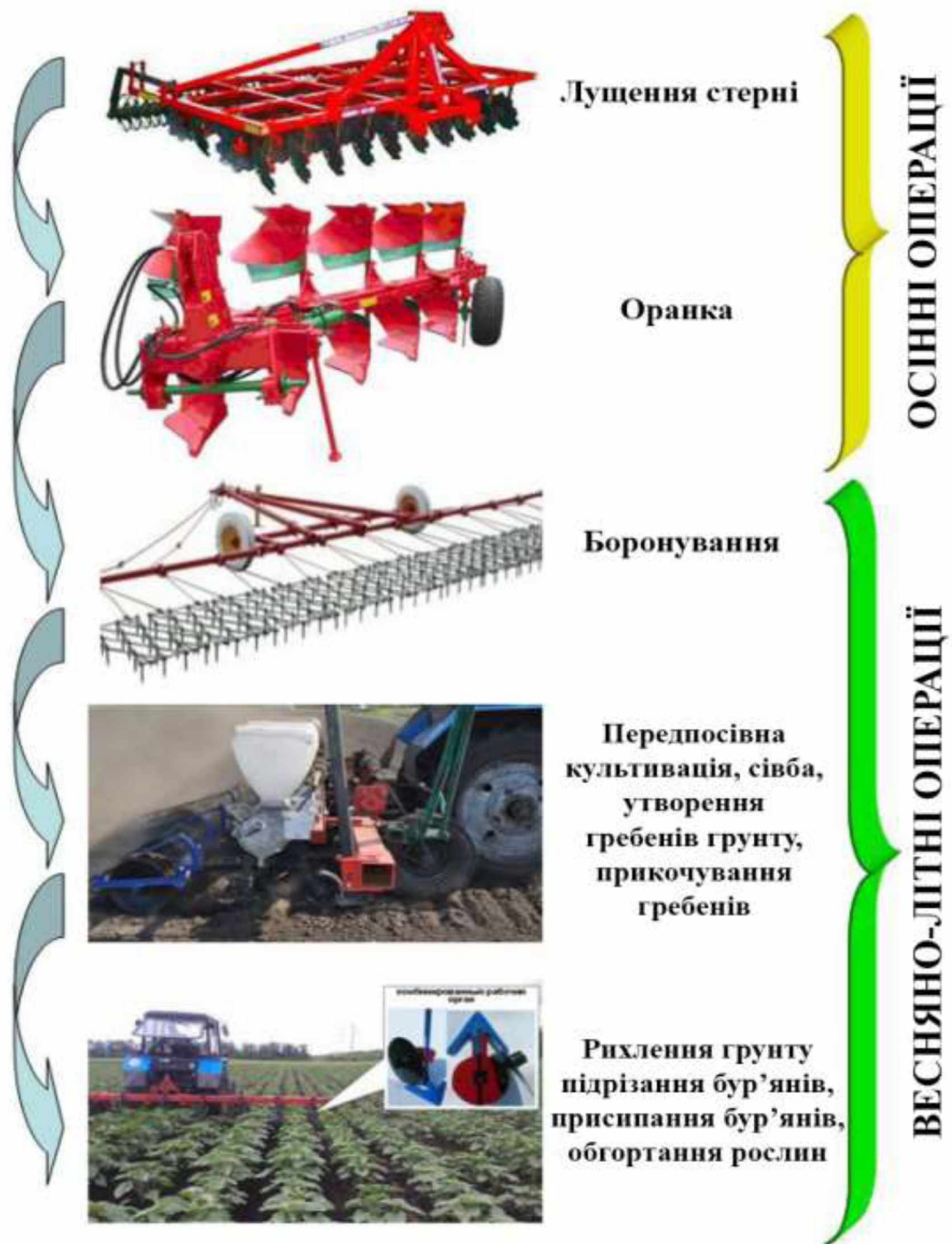
Рисунок 3.3 – Операції пропонованої технології гребеневого обробітку просапних культур
