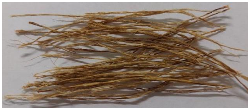
Рис. 3. Зовнішній вигляд текстильного волокна з хвої сосни звичайної після двохванної обробки при 100 °С та концентрації NaOH 50 г/л
