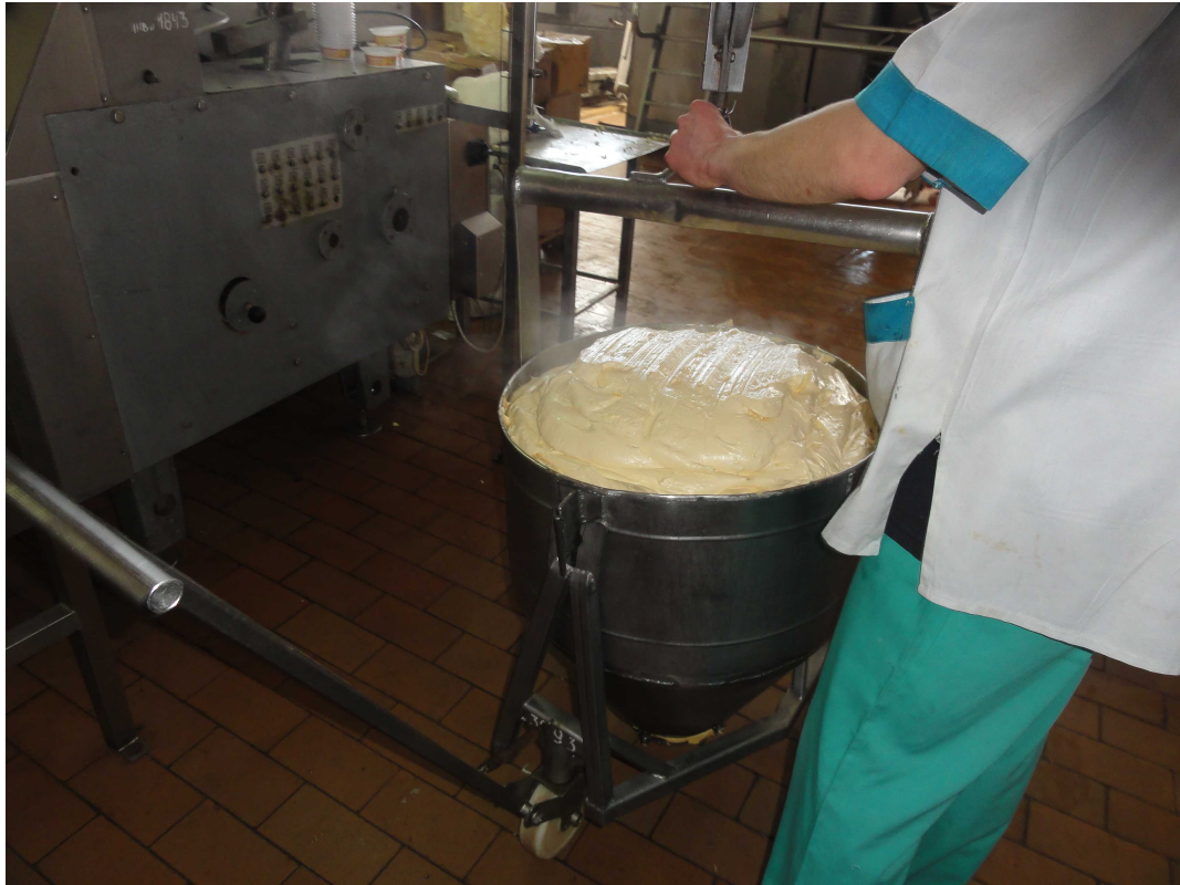
3.6. Вивантаження розплавленої сирної маси із котла-плавника
