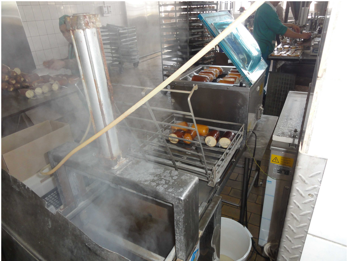
3.10. Упакування копченого сиру в термоусадочну плівку
