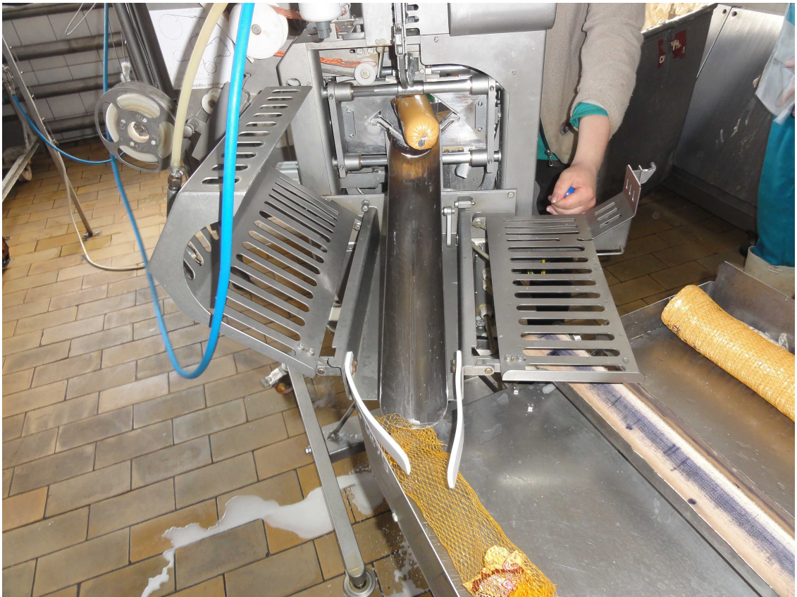
3.9. Автомат для фасування плавленого пастоподібного сиру
