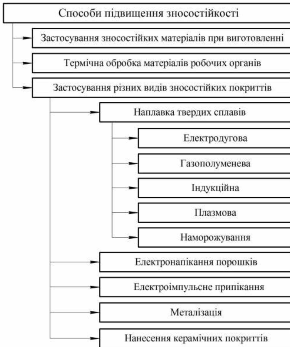
Рис. 1.8. Способи підвищення зносостійкості плужних лемешів
