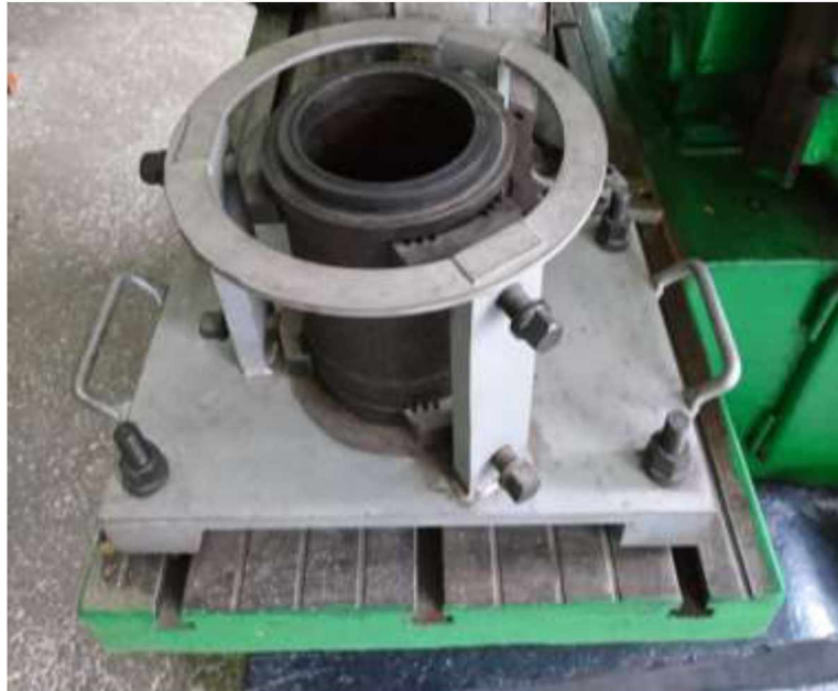
Рисунок 2.3. – Пристосування для центрування гільз циліндрів на станині верстату
