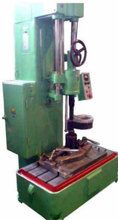
Рисунок 2.6. – Вертикально – хонінгувальний верстат модель 3Г833
