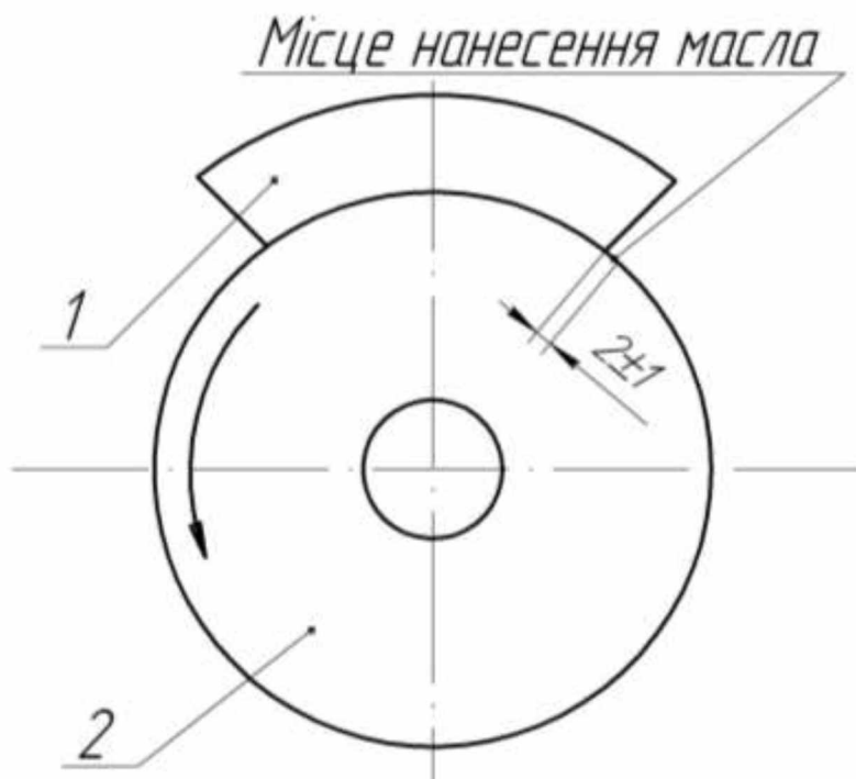
Рисунок 2.14. – Схема випробувань: 1 – зразок; 2 – контр зразок.
