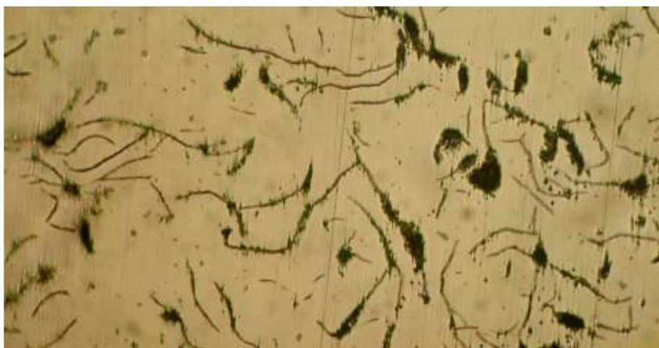
Рисунок 2.1. – Форма графіту початкового спеціального легованого чавуна (×300).
