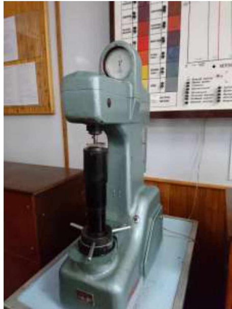
Рисунок 2.8. – Прилад для вимірювання твердості HRC по Роквелу
