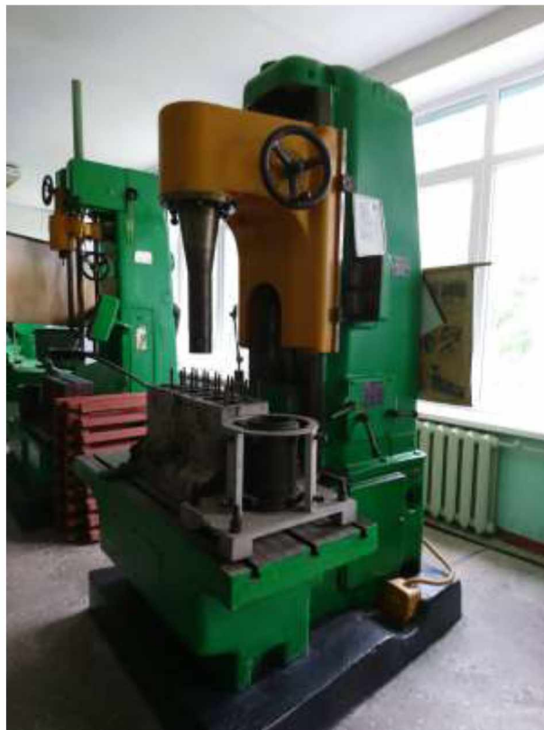
Рисунок 2.2. – Вертикально-розточувальний верстат 2Е78П (рис. 2.2)
