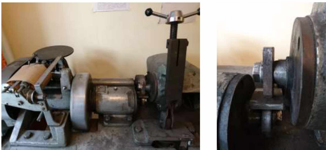
Рисунок 2.12. – Машина тертя МІ – 1М (машина Амслера).
