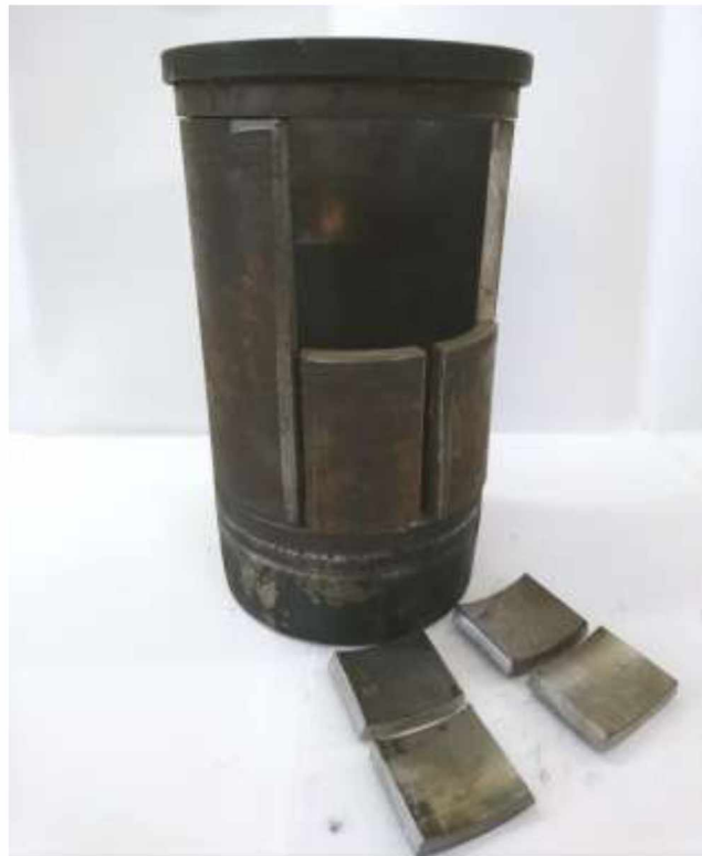
Рисунок 2.5. – Заготівки вирізані із стандартних гільз і розточених на ремонтний розмір
