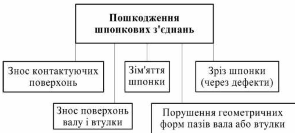
Рисунок 1.6 – Характерні види пошкоджень шпонкових з'єднань
