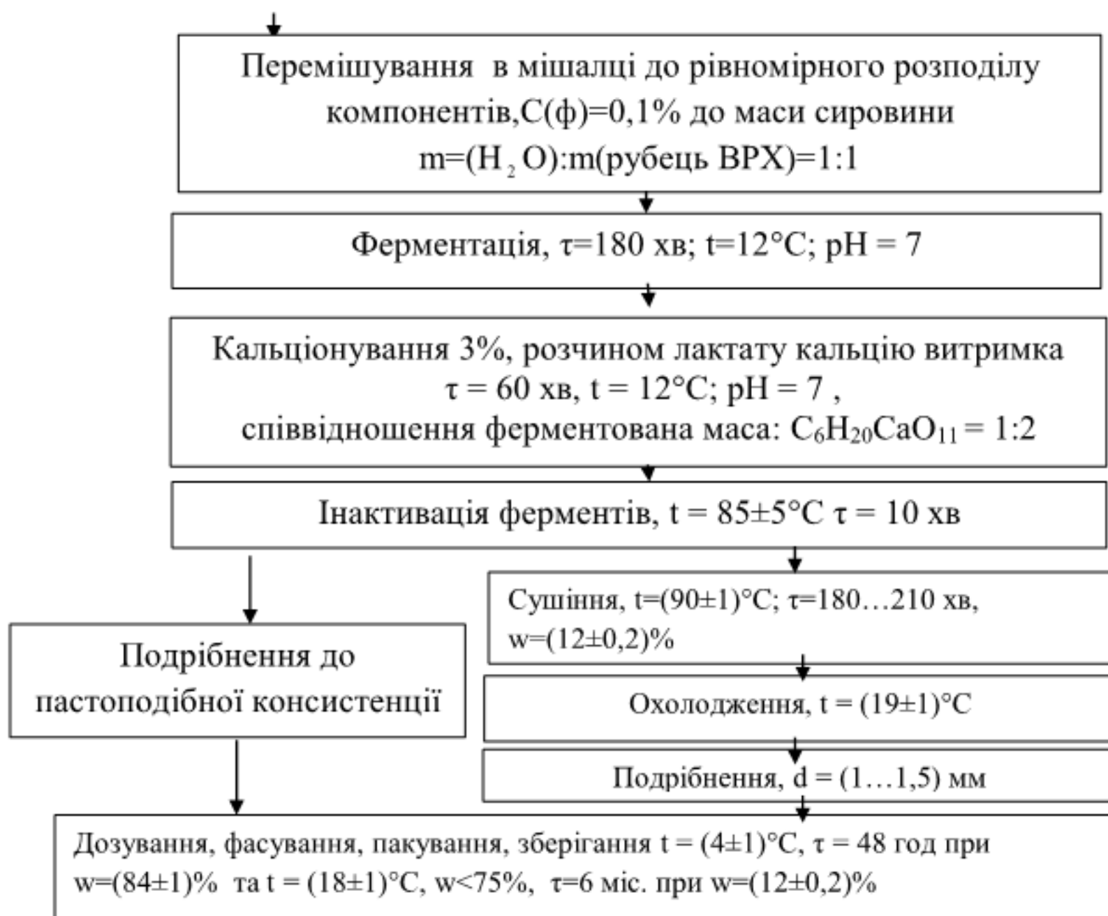
Рис. 3.11.- Технологічна схема виробництва білково-мінеральної добавки
