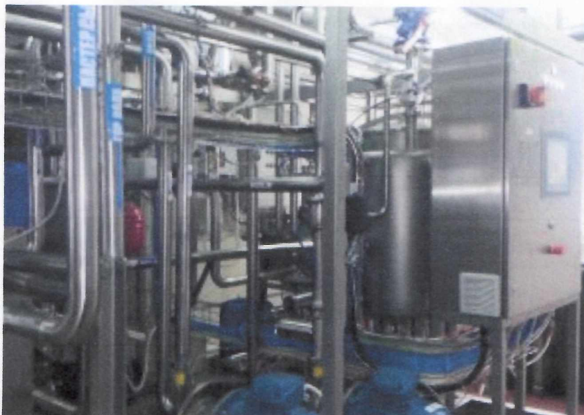
Рис. 3.5 Пластинчата-пастеризаційно охолоджувальна установка
