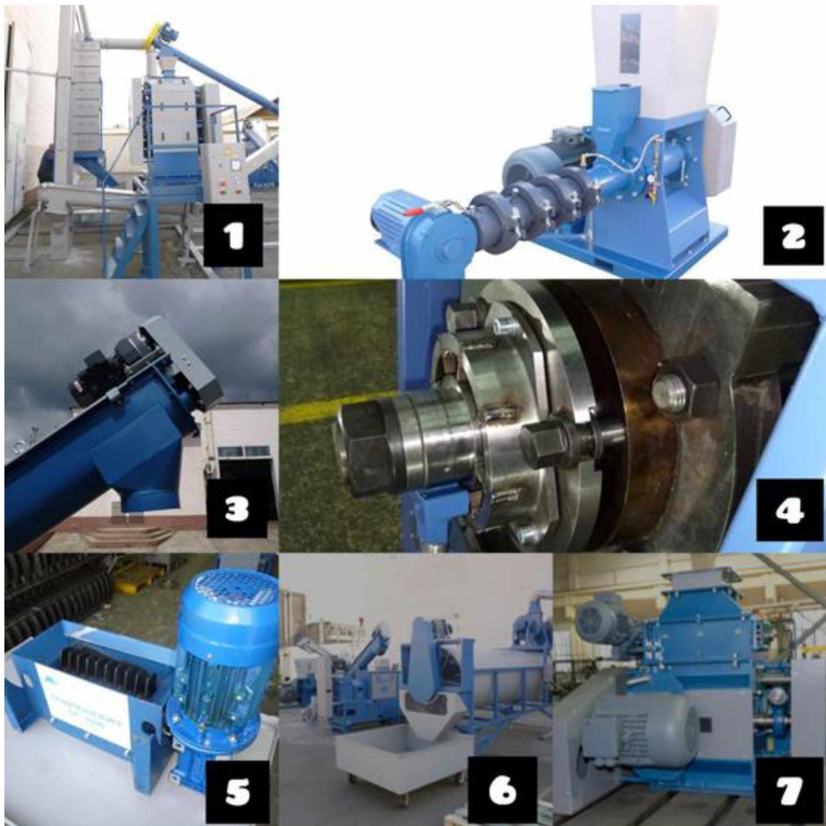
Рис.1.2 Обладнання для переробки сої: 1) луцилка сої LSG-4; 2) екструдер E-1000; 3) живильник SF-250; 4) олійний прес OP-1000; 5) макухоломач ОС-1000; 6) охолоджувач OE-1000; 7) дробарка вальцова SG-1.
