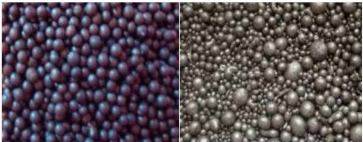
дріб сталевий литий, фракції 0,5; дріб сталевий литий, фракції 0,8
