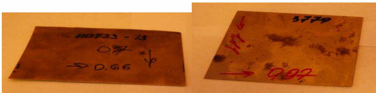
Рис. 2.2 – Зразки після обробки на дробеметній установці
