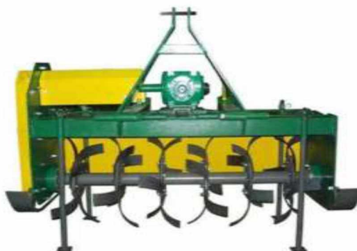
Рисунок 1.3 – Фреза ФН-1,2 для суцільного обробітку ґрунту
