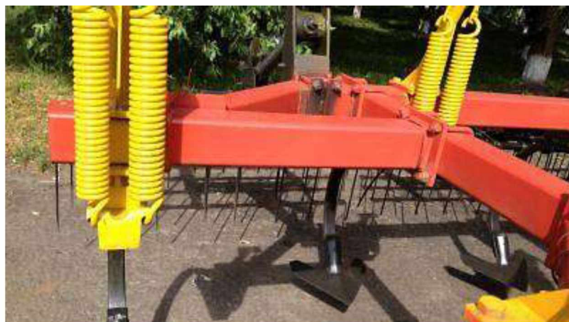
Рисунок 2.2 – Загальний вид кріплення стійки культиватора «Bourgault 8810» до рами
