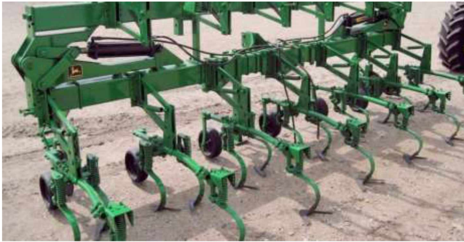
Рисунок 1.4 – Паралелограмна підпружинена підвіска культиватора Speed Bird.
