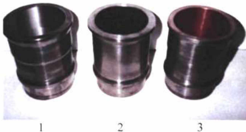
1 – після розточування; 2 – після ППД; 3 – після ФАБО
