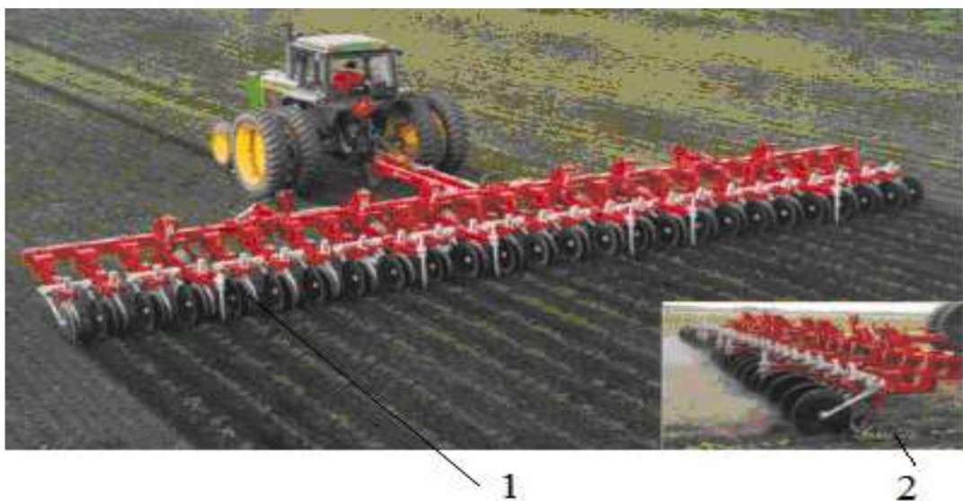
Рисунок 1.7 - Загальний вигляд культиватора Wil-Rich РТ-7722: 1 – рух МТА, 2 – технологічний процес міжрядної культивації [21]
