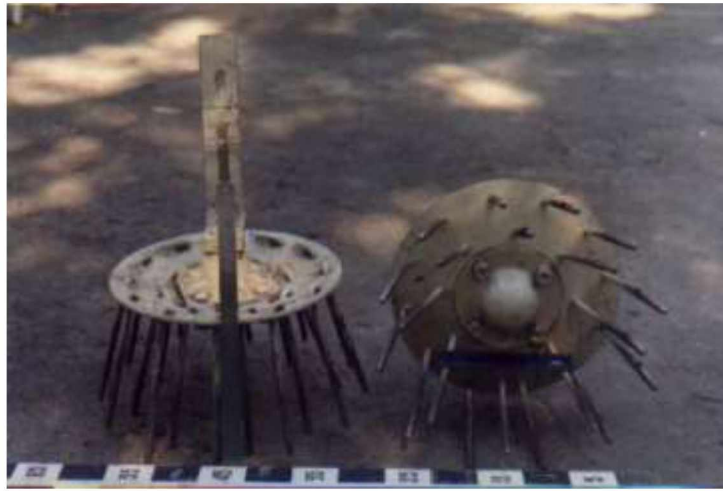
Рисунок 3.2 – ротаційні борони пасивного типу, якими пропоновано дообладнати культиваторну секцію машинно-тракторного агрегату МТЗ-82+КРН-4,2 під час проведення експериментальних досліджень з визначення якості просапної культивації.
