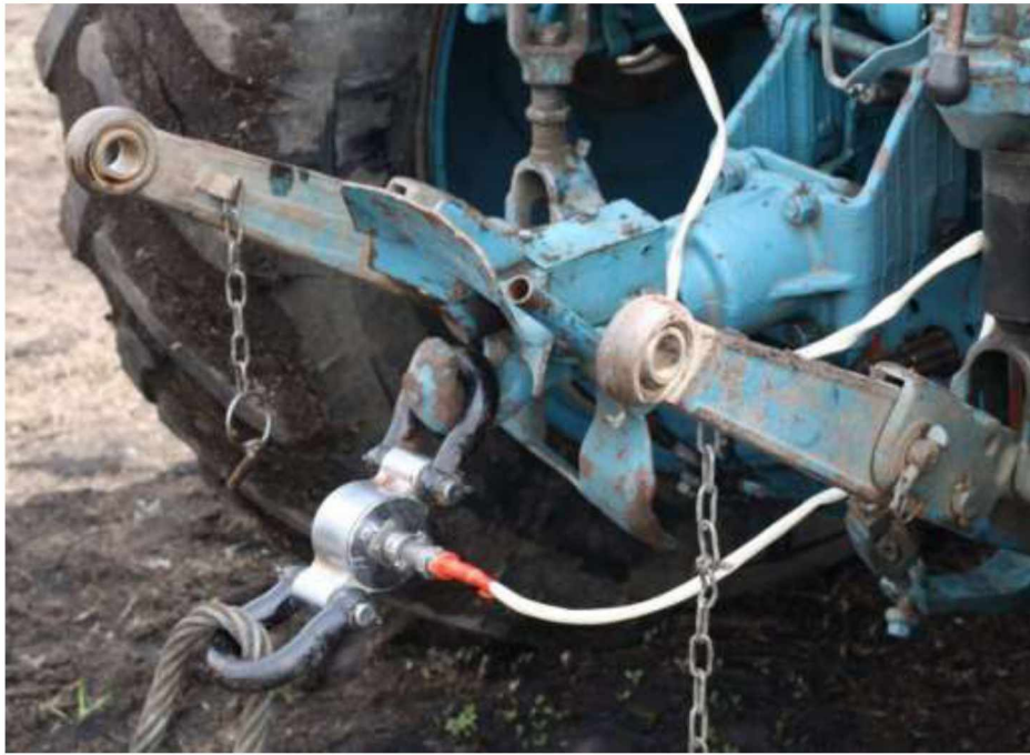
Рисунок 2.3 – Вимірювання тягового зусилля
