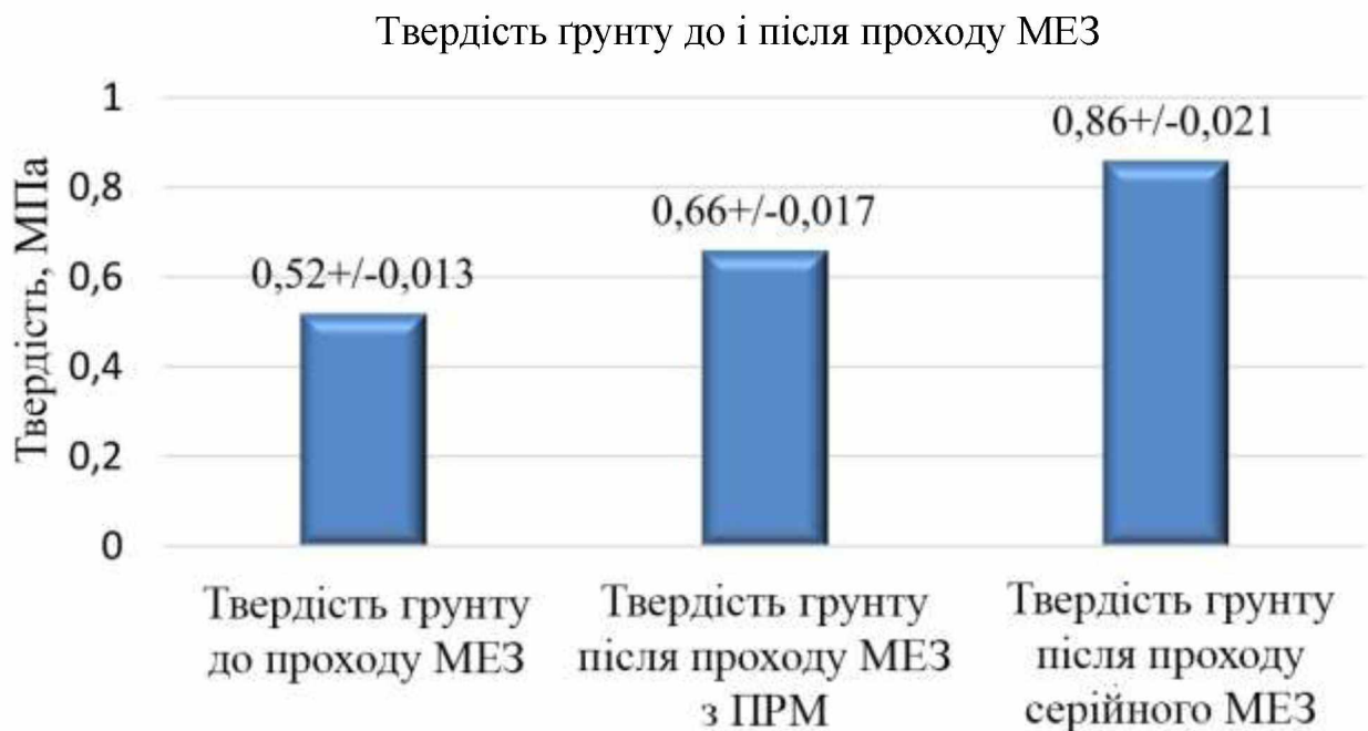
Рисунок 3.10 – Твердість ґрунту до і після проходу МЕЗ
