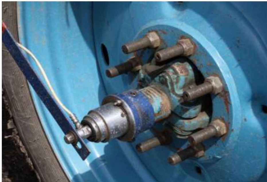
Рисунок 2.2 – Вимірювання частоти обертання ведучих коліс трактора
