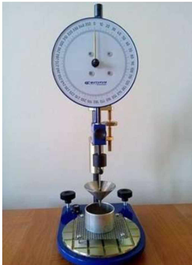
Рисунок 2.5 – Прилад М-984ПК для вимірювання penetрації пластичних мастильних матеріалів
