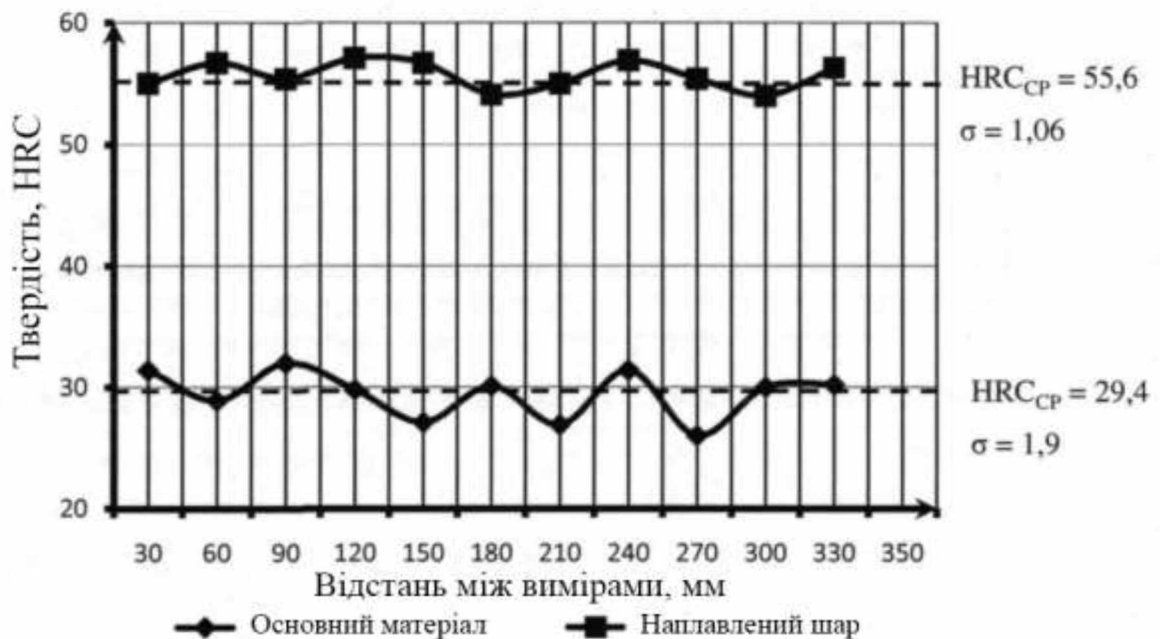
Рис. 3.19. Розподіл твердості основного матеріалу і наплавленого шару лемеша
