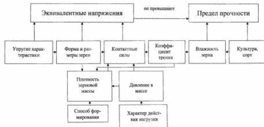
Рисунок 1. 2 - Схема взаємодії факторів які впливають на ушкодження насіння у зерновій масі
