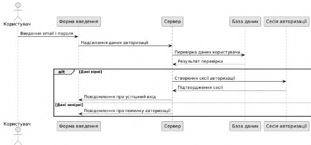
Рисунок 2.4 – Схема взаємодії користувача з модулем реєстрації та авторизації
