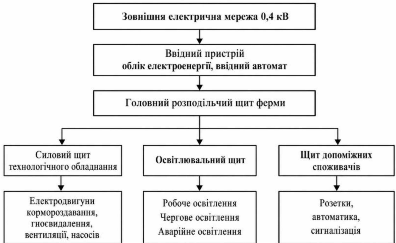
Рисунок 2.1 – Структура електропостачання ферми молодняка ВРХ
