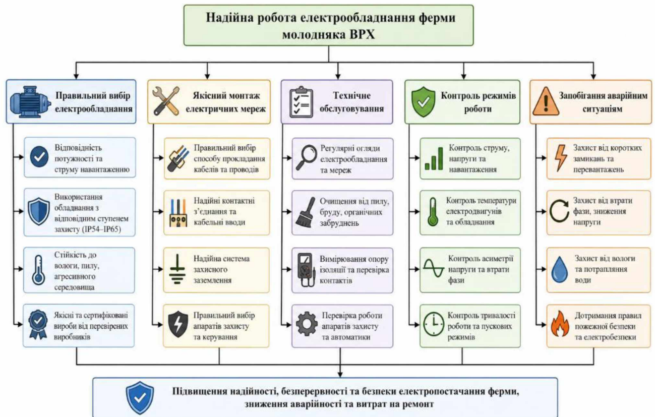
Рисунок 3.4 – Основні чинники надійної роботи електрообладнання ферми
