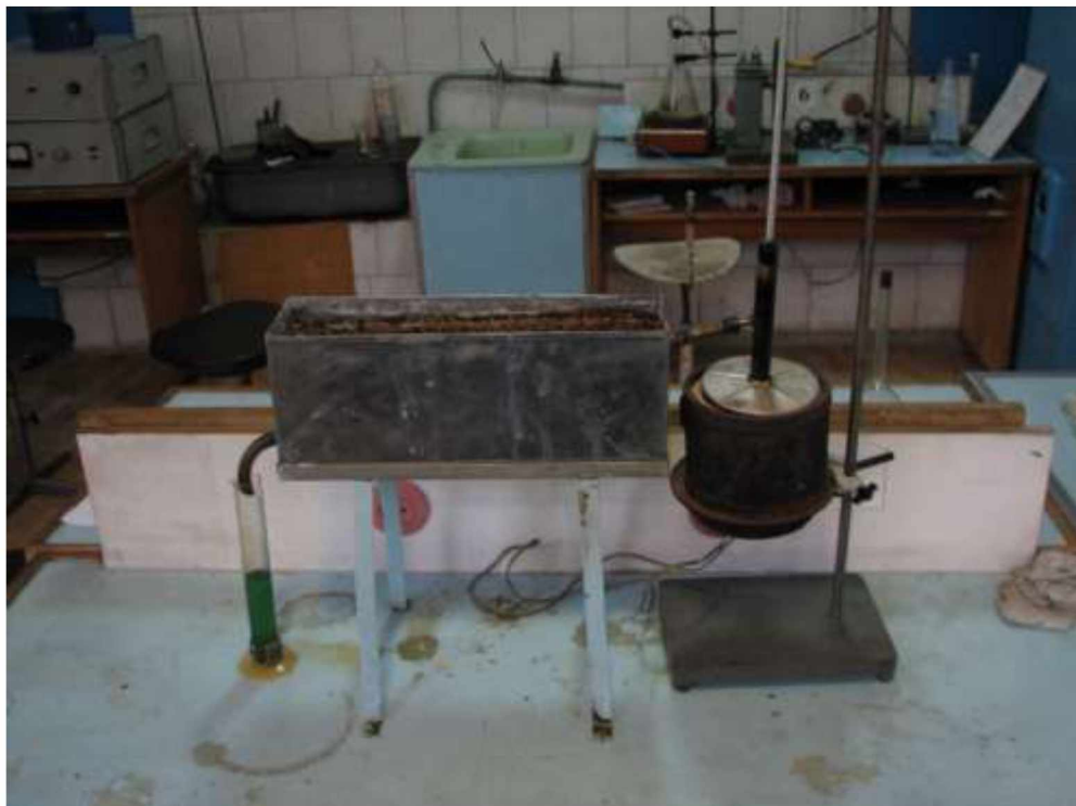
Рис. 3.3. Установка для розгонки нафтопродуктів
