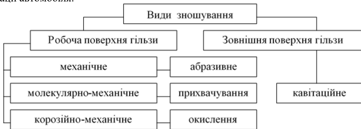
Рисунок 1. – Види зношування гільз циліндрів.
