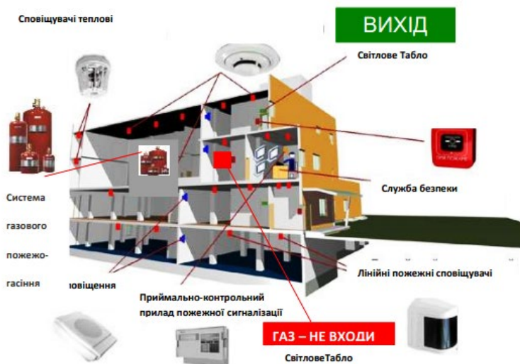
Рисунок 1 - Приклад використання систем пожежної сигналізації, автоматичного пожежогасіння та мовного оповіщення
