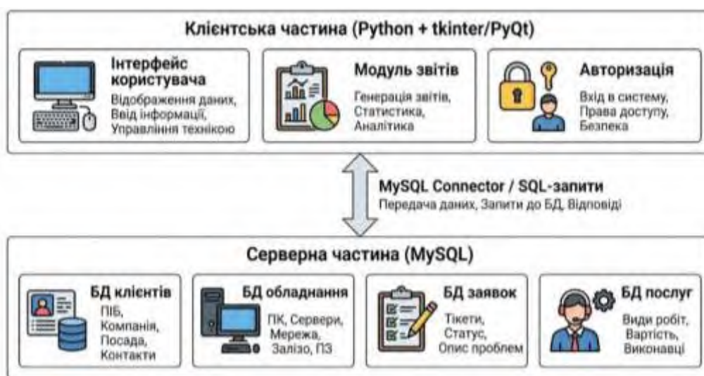
Рисунок 1.2 – Архітектура клієнт-серверної системи обліку комп'ютерної техніки
