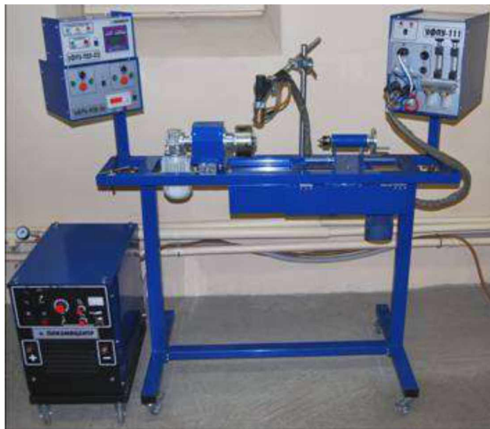
Рисунок 2.5 – Загальний вигляд установки для плазмового нанесення покриттів
