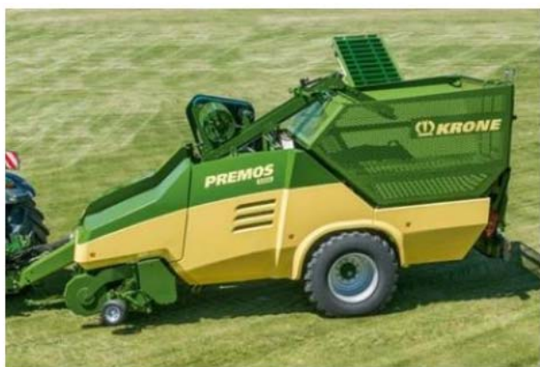
Рис. Польова машина для виробництва палетів у полі PREMOS 5000 компанії KRONE
