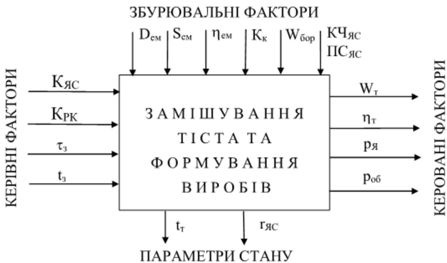
Рисунок 3.14.- Параметрична схема технологічного процесу замішування пісочного тіста з ядром насіння соняшнику та формування виробів
