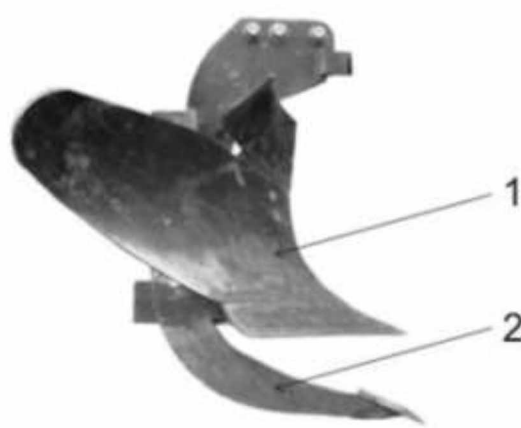
1 – корпус ПЛН-4-35, 2 – розпушувач
