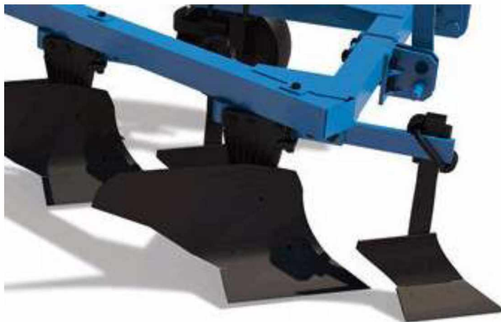
Рисунок 1.4 – Двох'ярусна відвальна оранка з розпушуванням
