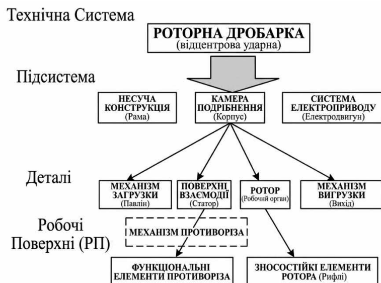
Рисунок 2.1 - Схема основних елементів дробарки
