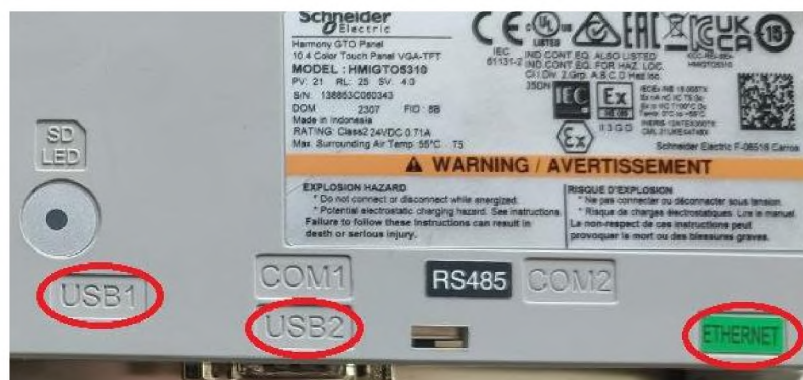
Рисунок 1.5 – Розміщення роз'ємів USB та ETHERNET на HMIGTO5310
