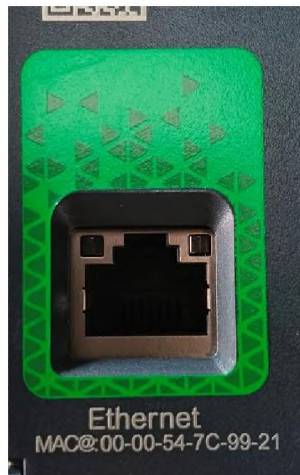
Рисунок 1.2 – Зовнішній вигляд Ethernet порту на контролері M241
