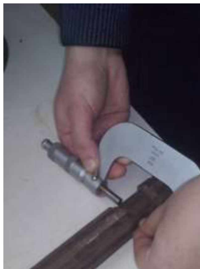
Рисунок 3.2 - Вимірювання розмірів первинного валу.
