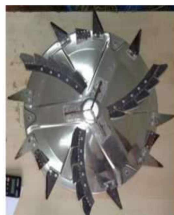
Рисунок 2.3-Загальний вид подрібнювача стеблових кормів, заготовлених в пресованому вигляді
