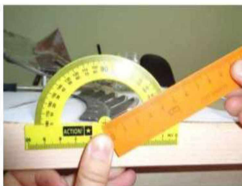
Рисунок 2.8 -Кут атаки горизонтальних зубчастих подрібнюючих елементів
