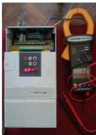
Рисунок 2.7 - Перетворювач частоти струму ELDI - 5.5 в комплекті з струмовими кліщами «Атакон АТК - 2200»
