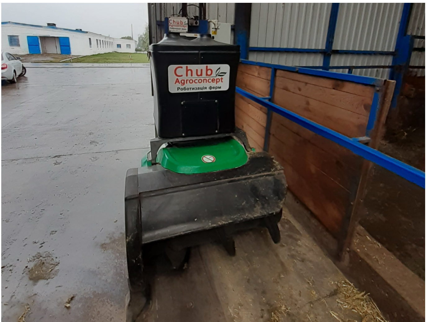
Рис. 3.8. Робот-підгортач Butler Gold
