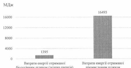
Рис. 2. Витрати енергії виробленої біологічним і промисловим шляхом для вирощування 70 ц/га зерна пшениці озимої Джерело: авторські дослідження.
