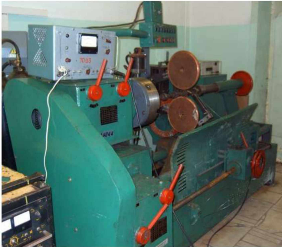
Рисунок 2.5 – Установка для електроконтактного зварювання
