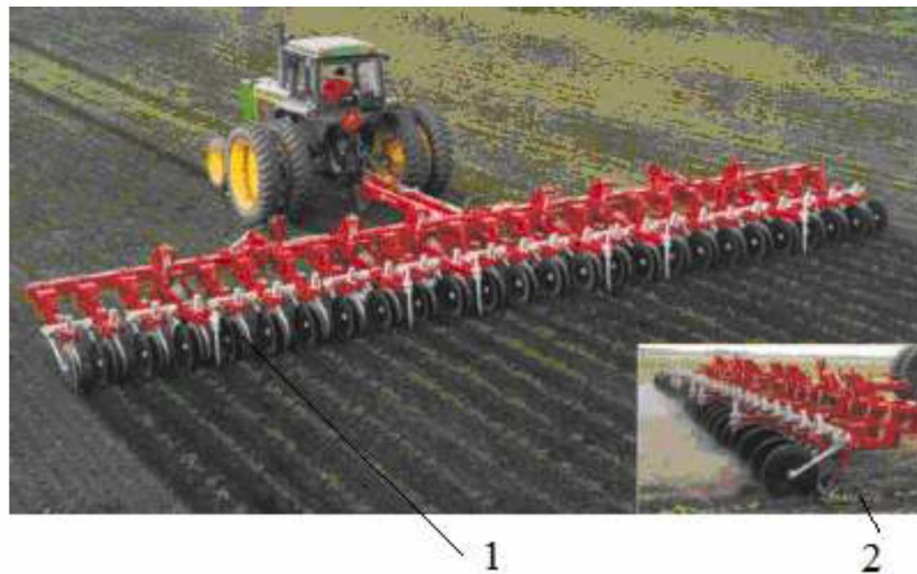
Рис.1.7. Приклад використання культиватора «Wil-Rich РТ-7722»: 1 – рух агрегату по полю, 2 – технологічний процес міжрядної культивації [21]
