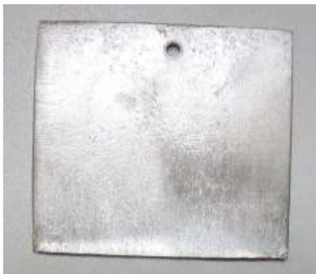
Рисунок 2.2 - Сталевий зразок для випробувань на корозійну стійкість
