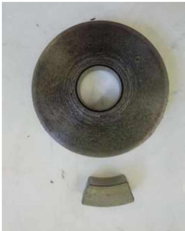
Рисунок 2.1 - Загальний вигляд пари тертя колодка-ролик
