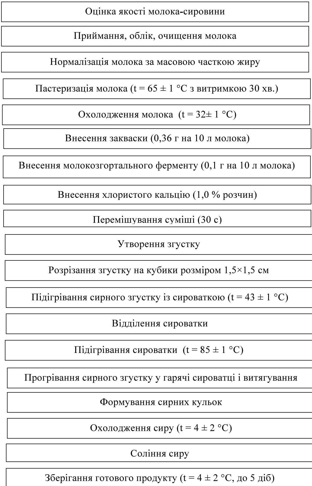
Рис. 3.3. Схема виробництва сиру моцарела із заквашувальною культурою прямого внесення і хлористим кальцієм
