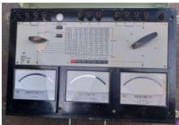
Рисунок 2.11 – К-505, пристрій для вимірювання потужних характеристик
