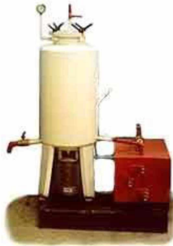
Рисунок 1.14 - Комплект обладнання для виробництва кормового соєвого молока СКК-60 (СКК-500)
