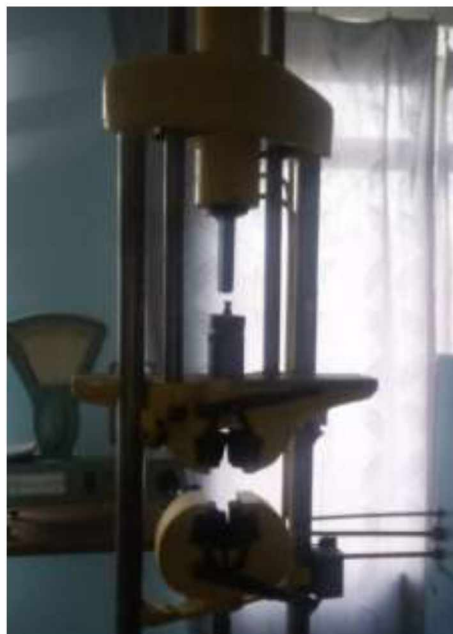
Рисунок 2.3 – Загальний вигляд машини для дослідження на розрив
