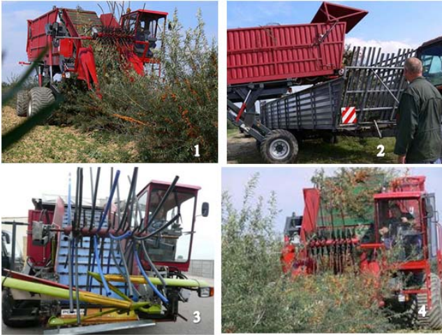
Рис. 94. Комбайн компанії «Кранеманн» для зрізування гілок рослин обліпихи у процесі роботи: 1, 4 – комбайнування, або зрізування гілок з плодами; 2 – відвантаження урожаю на транспортну систему; 3 – елементи комбайна – мотовило, розподільвачі, транспортуюча система, жатка та ін. [92]
