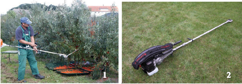
Рис. 96-1,2. Обладнання для збирання плодів обліпихи: 1 – модернізований ручний віброударний струшувач SC 105 (загальний вигляд); 2 – мотопристрій Bergy Shaker HK2 [25]
