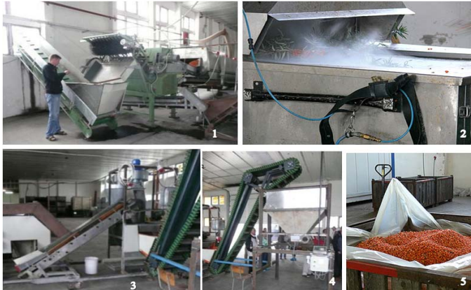
Рис. 95. Технологічний процес з відділення плодів обліпихи від гілок у компанії «Кранеманн», Німеччина: 1 – система ділення урожаю на компоненти – плоди, лиски, гілки; 2 – система шокowego заморожування плодів; 3 – сепаратор, або система відділення ягід від листків; 4 – транспортуюча система для очищених плодів; 5 – контейнер з плодами, підготовлений до заморожування [92]
